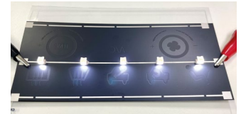
Leitfähige Tinte als Ersatz für Kabelbäume
